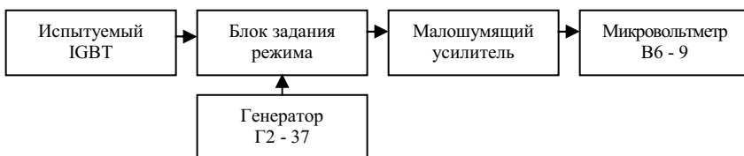
Рис. 1. Структурная схема установки для измерения параметров собственного шума
