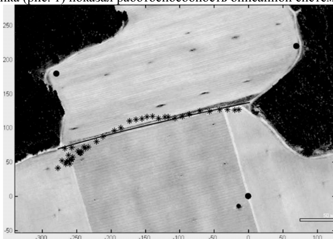
Рис. 1. Трек движения постановщика помех. (Линия — трек движения излучателя помех, звездочки — определенные координаты с темпом 1 с., кружки — приемники)
